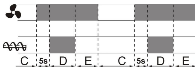
Obr. 9 Pracovní cykly ventilátoru a podavače v režimu ÚTLUM, kde: C – Prodleva chodu podávání v režimu Útlum, D – čas chodu podavače v režimu Útlum, E – Doběh ventilátoru v režimu Útlum.
